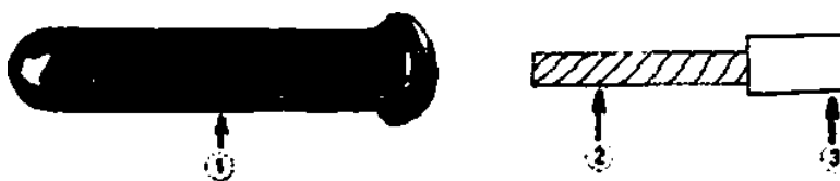
Г — колпачок. 2 — оголенный провод: 3 — изоляция
